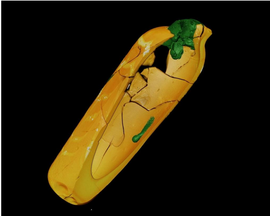
Figuur 5. Reconstructie van object 504 (Allard Pierson) op basis van de micro röntgen CT-scan in valse kleuren. Het sterker verzwakkend het materiaal, hoe helderder de kleur. In het groen is een nauwelijks verzwakkende restauratie weergegeven.
