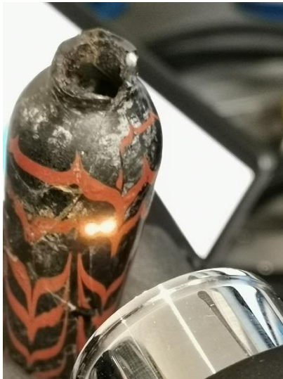
Figuur 19. OCT metingen aan object 504 (Allard Pierson). De OCT scans laten de aanwezigheid van een oppervlaktelaag zien en er kan onderscheid gemaakt worden tussen het zwarte en rode glas.
